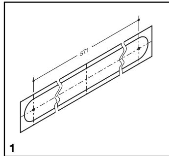
**D** Anreißschablone an Mittellinie ausrichten. Bohrpunkte anzeichnen.
